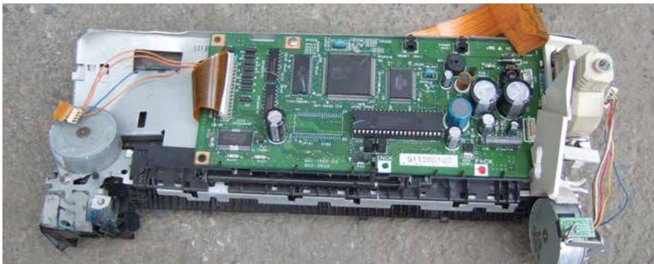
Miljøgifter i EE-avfall sitter ofte i kretskort, men kan også finnes i plasten. På bildet vises et kretskort med kondensatorer. Foto: Miljødirektoratet ved Arnstein Flatlandsmo.
