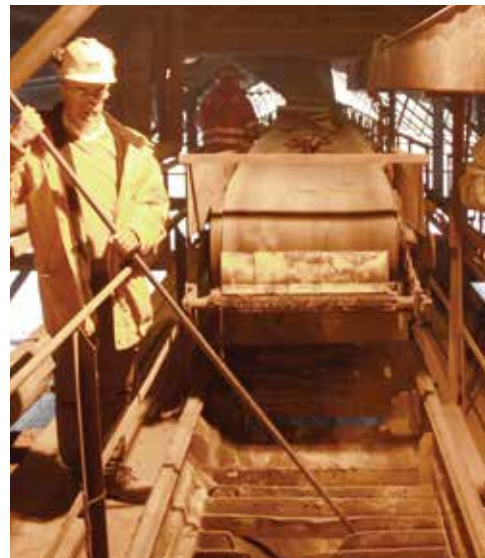
Etter ulykken: Ribber på nedfall er vendt 90 grader, slik at det er lettere å stake fra siden.
