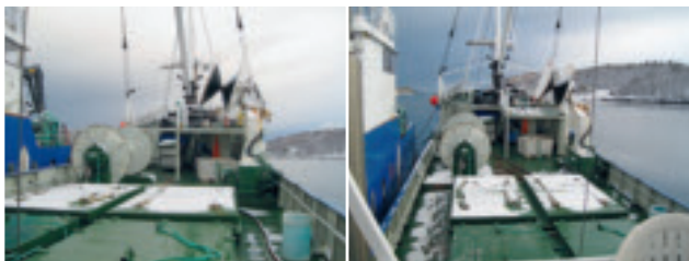
Bildet viser blokken på styrbord side og trommelen på babord side av dekket.
