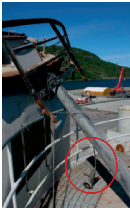
Vinkelsliperen slik den lå da den ble sikret av politiet. Gnister fra vinkelsliperen antente hydrogengass fra tanken gjennom åpning i tanktaket.
