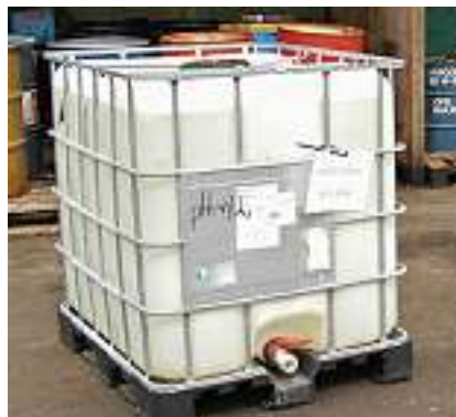
En av containerne som ble brukt til å samle opp det ammoniakkholdige vannet fra kjøleanlegget til pizzabakeriet. En såkalt IBC-container. Foto Sveinung Bakken, Asker og Bærum politidistrikt.
